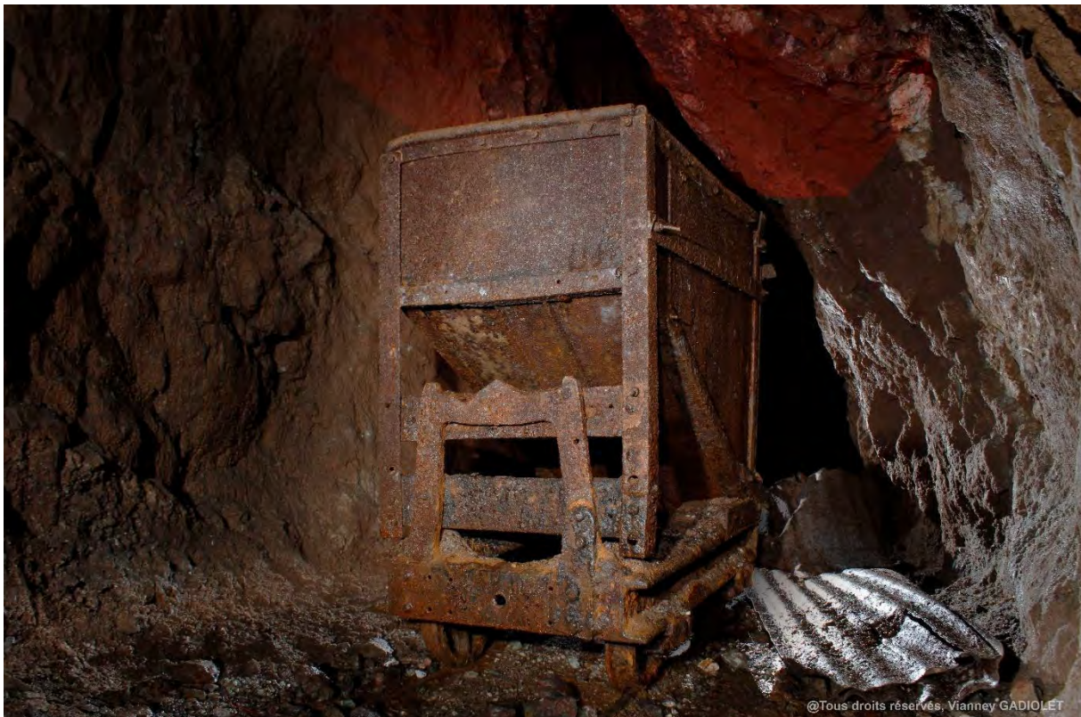
Berline de récupération de type Decauville fabriquée à partir d'éléments plus anciens (fin XIXème siècle certainement). Filon des Grandes Terres
